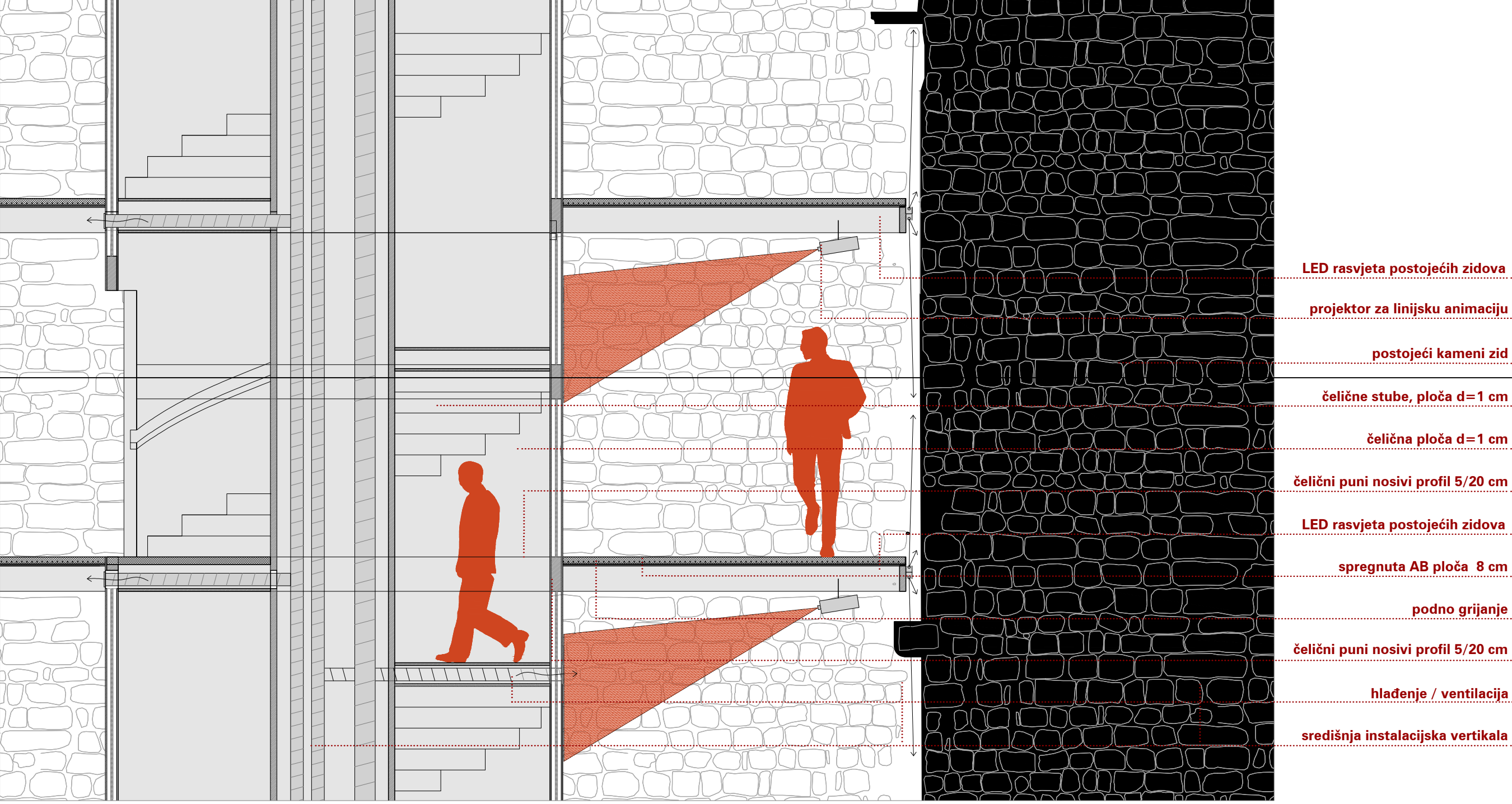
DETALJNI PRESJEK KROZ KULU KAMERLENGO M 1:33
